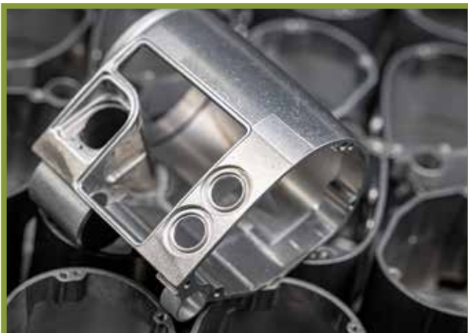
Come nasce un binoculare di alta qualità. Uno dei due tubi dell'alloggiamento del Geovid R è appena uscito dal macchinario che lo ricava dal pieno dalla barra di metallo.
